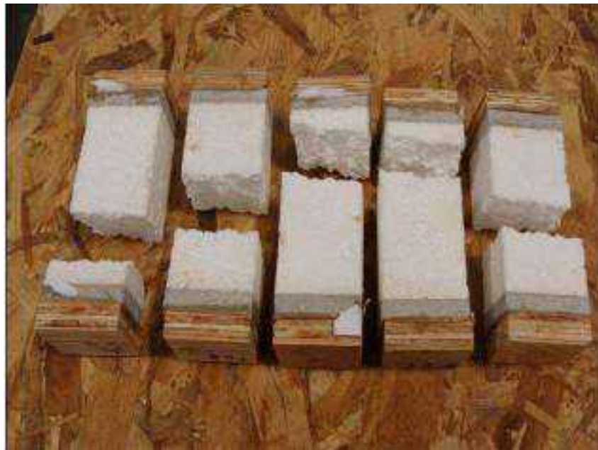
C297 Tensile “Controls”
